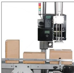
Étiquetage sur des objets mobiles de différentes tailles. Jusqu'à 30 étiquettes par minute.
